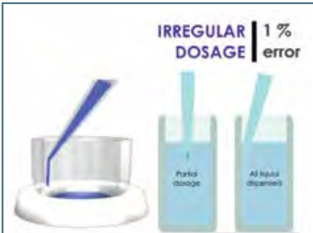
Şekil 4: Solda gördüğünüz şekil numunenizi dağıtırken pipet ucunuzu kabının cidarına değdirip yaklaşık 30-45 derecelik bir açıyla sıvınızı boşaltmanız gerektiğini göstermektedir. Sağdaki şekilde ise eğer bu şekilde yapmaz iseniz pipetlemenizde %1'lik bir hata meydana gelecektir.
